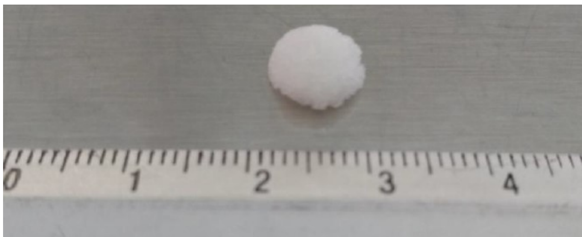
Figura 3. Andamio de PLA/nMg (80/20 wt%). Los andamios porosos obtenidos en forma de cilindros de 1cm de diámetro por 0.3 cm de ancho, tamaño óptimo para posteriores estudios en cultivo celular.
