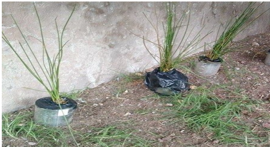
Figura 2. Montaje de los sistemas de remoción de sulfato a partir de la macrofitas con y sin sustrato.
